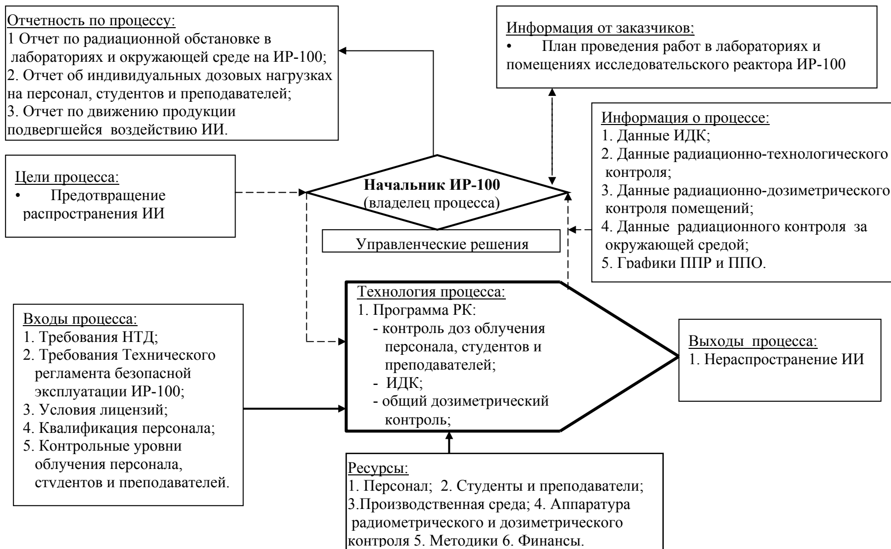
Рис. 3 - Концептуальная структура процесса радиационного контроля на исследовательском реакторе ИР-100
