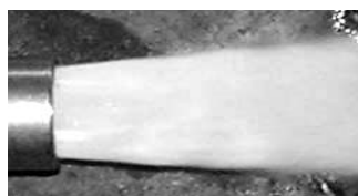
Рис. 5. Истечение вскипающей жидкости из конического канала активного сопла
