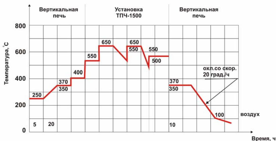
Рис. 6. Режим комбинированного отпуска отработавшего ресурс моноблочного прокатного вала для дальнейшего вторичного использования
