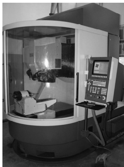
Фото 4 Заточной станок Helitronic Power Regrinder
