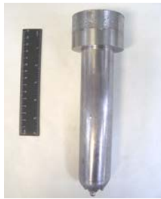
Рис. 4. Пропресована трубна заготовка з кутом робочої частини ігли \alpha = 15^\circ
