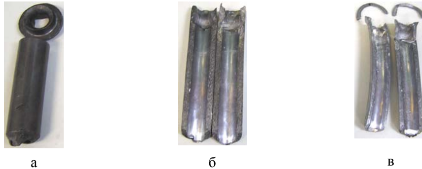
Рис. 10. Вплив кута воронки матриці на величину прес-утяжини.
