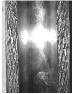
Рис. 2,б. Здеформована координатна сітка після суміщеної прошивки і пресування.
