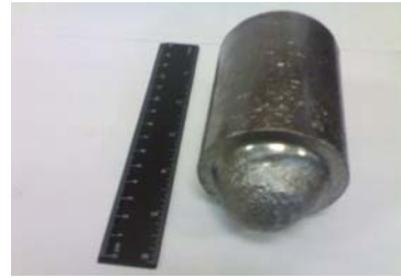
Рис.5. Початок утворення передньої пробки
