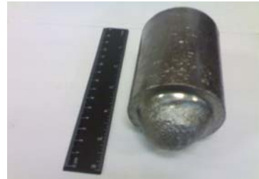
Рис.5. Початок утворення передньої пробки
