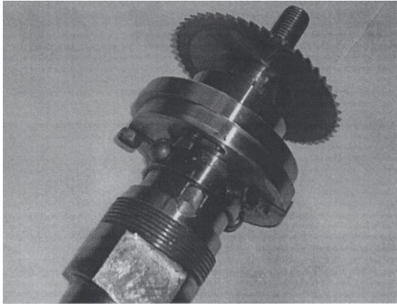
Рис. 2. Фрезерна оправка із зміщеним центром осі обертання фрези
