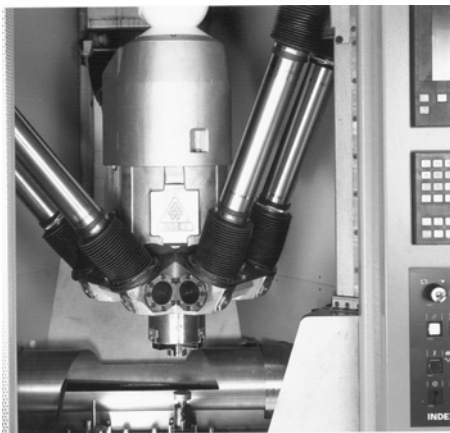
Рис.3 Токарный станок V100 на базе МПС фирмы Index-Werke
