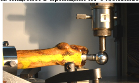
Рис. 2 Випробування системи «кістка - імплант»
